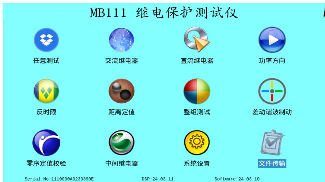
各测试模块独立，通过触摸点击或鼠标光标点击进入对应的测试模块完成测试任务。
