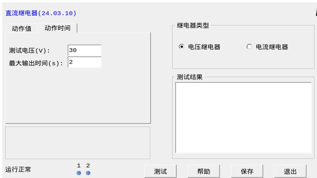
**测试逻辑:** 输出测试电流或测试电压, 时间为“最大输出时间”, 如果保护未动作则自动停止, 如果保护动作则立刻停止输出并显示动作时间。
