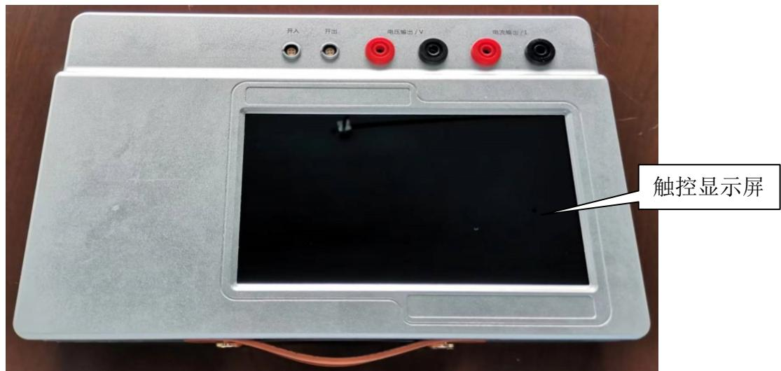
外围接口：包含一路电压输入，一路电流输入，一组航空头开关量开入、开出。
