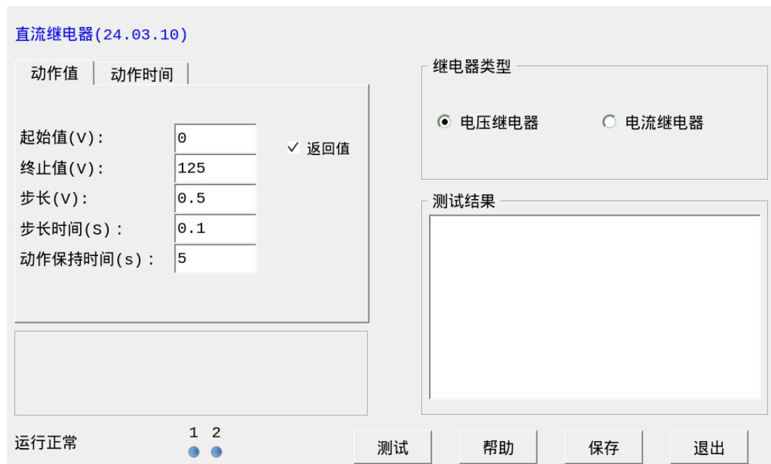
**测试逻辑：**测试开始后电流或电压按照设置的起始值、步长、步长时间输出。如果输出到终止值，保护一直未动作，则停止输出；如果在过程中保护动作，则得到动作值，然后查看有没有勾选“返回值”选项，如果没有勾选则停止测试，如果勾选“返回值”则输出按动作值返回，测试得到返回值后停止测试，报告中显示动作值，返回值和返回系数。
