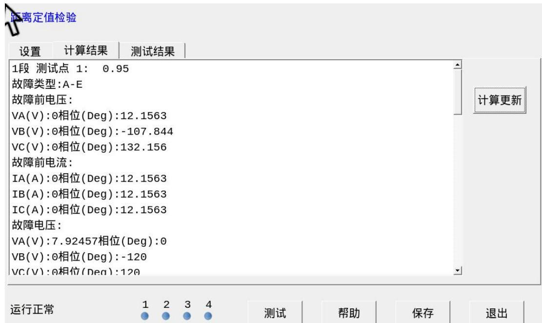
第四步：开始测试，按面板上的“测试”键进行测试；
