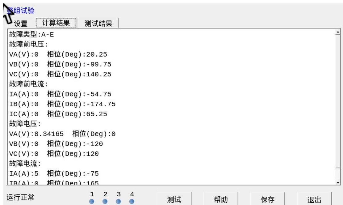
第五步：按下“测试”按钮开始测试。测试自动运行并且测试完
