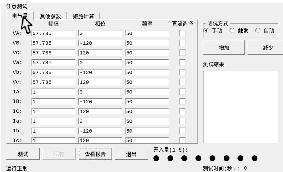
本模块有三种测试方式，分别是“手动”、“触发”、“自动”。
