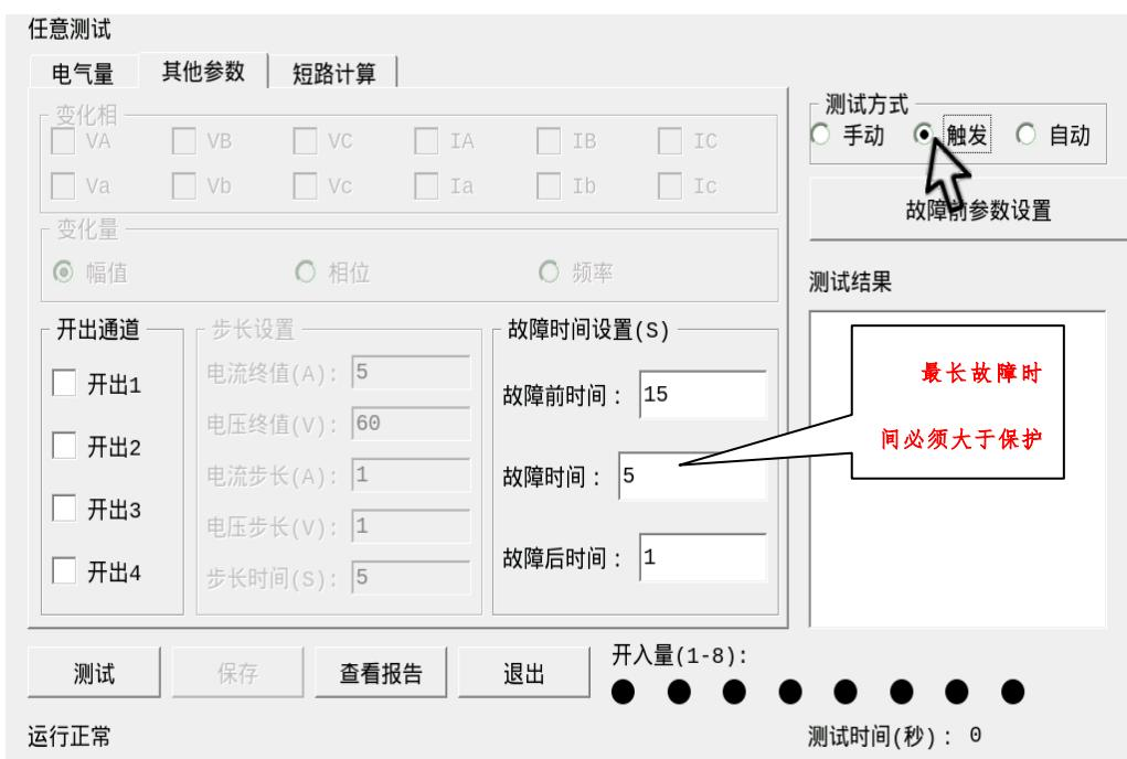
第二步、点击“故障前参数设置”按钮，设置“故障前信号”，故障前一般为正常态。界面如下：
