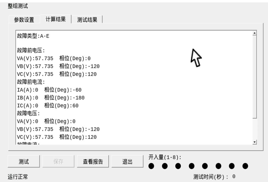
第五步：按下“测试”按钮开始测试。测试自动运行，测试完成后可以在“测试结果”界面中查看结果。
