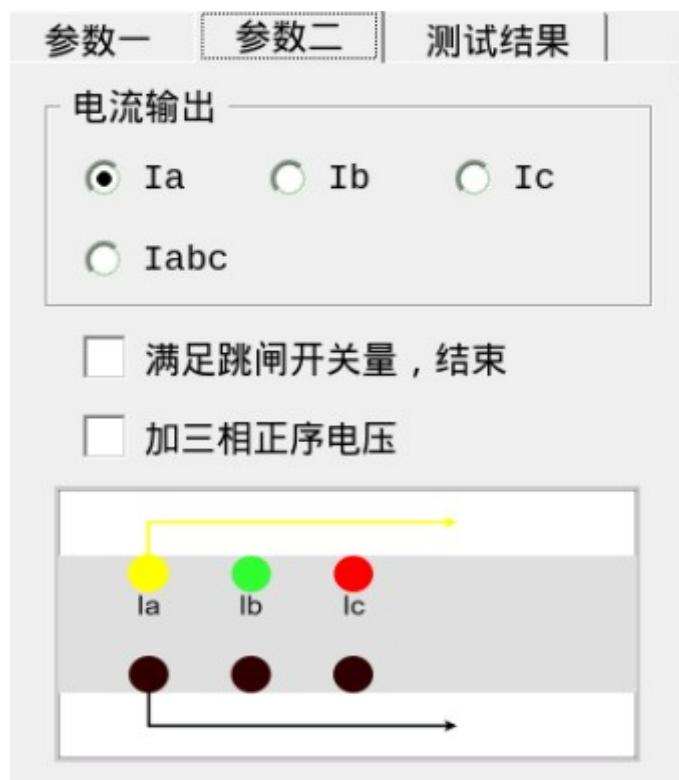
第二步：选中“ 满足跳闸开关量，结束”，指满足开关量的动作条件时，结束输出。（当选定此选项时，表示只要接点动作，测试就全部结束，如果需要描出动作曲线，请不要选中此选项）
